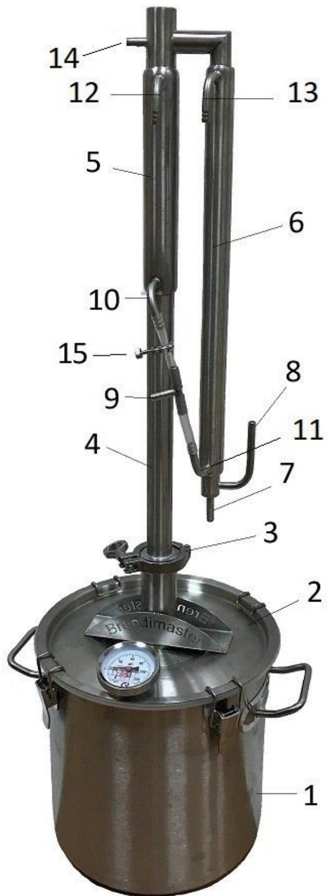
Рисунок 2. Строение бражной колонны «Пять звезд»
